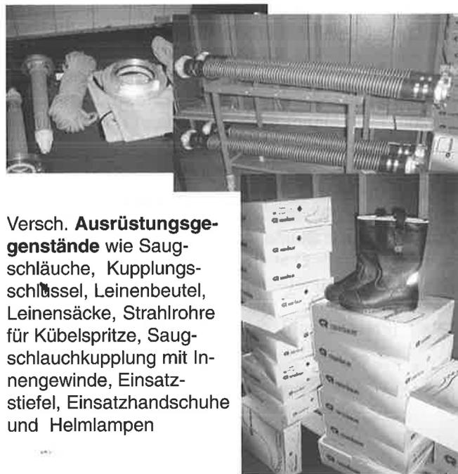
Versch. **Ausrüstungsgegenstände** wie Saugschläuche, Kupplungsschlüssel, Leinenbeutel, Leinensäcke, Strahlrohre für Kübelspritze, Saugschlauchkupplung mit Innengewinde, Einsatzstiefel, Einsatzhandschuhe und Helmlampen
